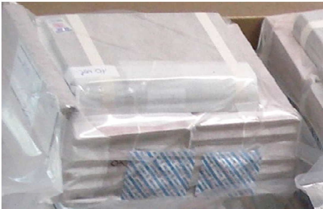
Figura 1. Bolsa contendo livros em tratamento de desinfestação por anóxia; acima, à esquerda o indicador de oxigênio (a cor rosa confirma a condição anóxia) e ao centro os absorvedores de oxigênio.
